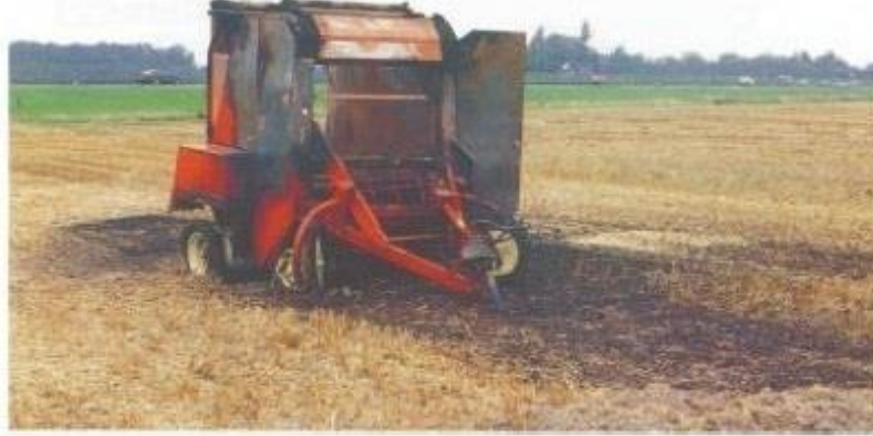
Hatalı kullanım nedeniyle yanmış bir yuvarlak balya makinesi
